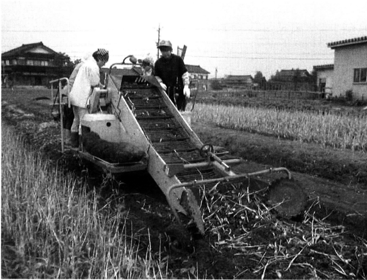
写真6. ポテカルゴによる掘り取り作業の様子
